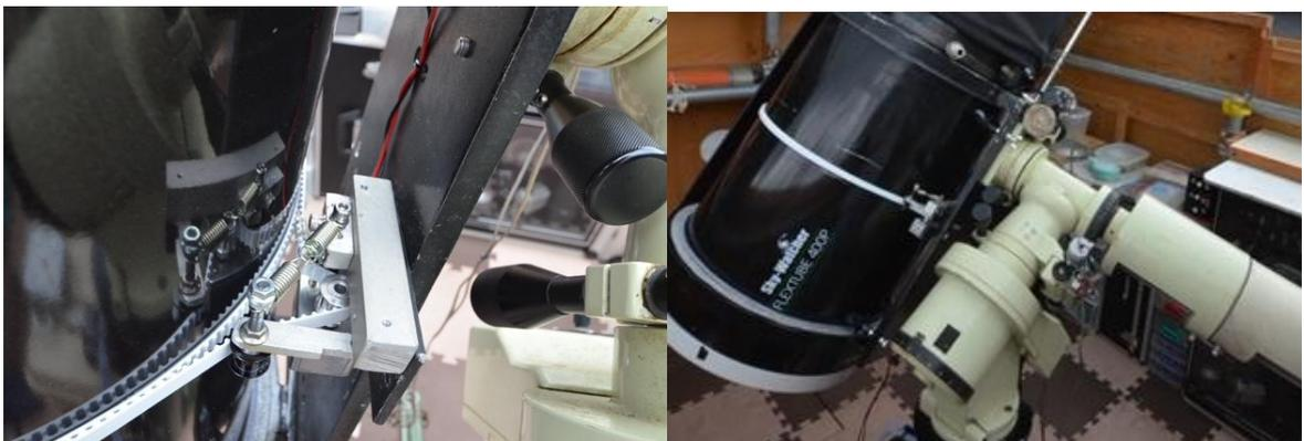
鏡筒にバンドを両面テープで一巻きして、その外側にバンドを巻き、駆動用のプーリーを DC モーターで回転できるようにしました。(左図) 鏡筒は天頂に向けると回せるようにできており、この
